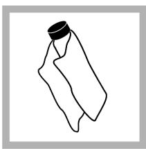
**6.** استخدم قطعة القماش المبللة بالزيت لوضع الزيت بالتساوي على سطح الزجاجة. قم بزاله معظم الزيت. تأكد من أن الزجاجة جافة تقريرًا.
