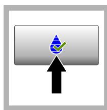
**3.** اضغط على **Verification** (التحقق). تظهر القيمة القياسية للتحقق. اضغط على **Options > Verification > Setup** (خيارات > تحديد التحقق) لتعديل قيمة معيار التحقق.
