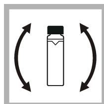
8. 試料セルを優しくゆっくりと反転攪拌して、試料を十分に攪拌します。気泡が生じないように注意してください。
