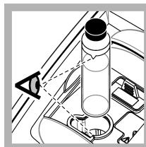
7. バイアルの三角マークと試料セルホルダーの基準マークを合わせて、バイアルを試料セルホルダーに入れます。クリック音が聞こえるまで、ふたを押して閉じます。
