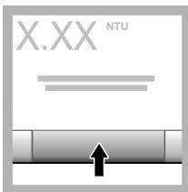
15. [Verify after Cal (校正後の検証)] をオプションに設定した場合は、検証標準液の値が表示されます。[Read (測定)] を押して、検証標準液を測定します。
