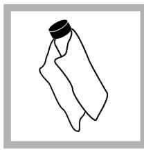
7. استخدم قطعة القماش المخصصة للتزييت المتوفرة لوضع الزيت بالتساوي على سطح خلايا العينة. قم بزالة الزيت الزائد. تأكيد من جفاف خلايا العينة تقريباً.
