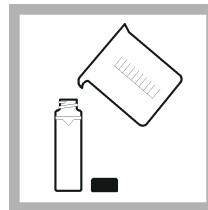
4. สำรองเชลล์ใส่ตัวอย่างที่ว่างเปล่าและสะอาดสองครั้ง ด้วยสารละลายที่จะใช้ตรวจวัด และเทน้ำทึบ เทตัวอย่างจนถึงสัก (ประมาณ 30 มล.) และปิดฝาเชลล์ใส่ตัวอย่างทันที
