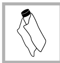
9. استخدم قطعة القماش البليطة بالزيت لوضع الزيت بالتساوي على سطح الزجاجة. قم بازالة معظم الزيت. تأكد من أن الزجاجة جافة تقريباً.
