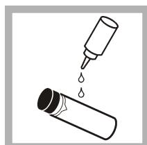
6. 試料セルの上部から底部まで少量のシリコンオイルを塗布します。
