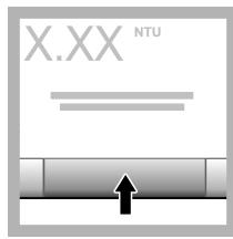
**15.** إذا تم تعيين Verify After Cal (التحقق بعد المعايرة) إلى On (تشغيل)، فستظهر قيمة معيار التحقق. اضغط على **Read** (قراءة) لقياس معيار التحقق.
