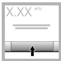
**15.** 교정 후 확인이 켜짐에 설정되면 확인 표준의 값이 표시됩니다. 판독을 눌러 확인 표준을 측정합니다.
