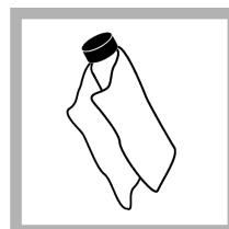
7. ใช้ฟันเชลล์น้ำมันที่ให้มา เก็บน้ำมันที่ให้เสมอต้นทั่วพื้นผิวดของเชลล์ใส่ตัวอย่าง เช็ดน้ำมันที่เก็บออก ควรดูว่า เชลล์ใส่ตัวอย่างเก็บจะแห้งสนิท
