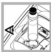
11. パイアルの三角マークと試料セルホルダーの基準マークを合わせて、パイアルを試料セルホルダーに入れます。クリック音が聞こえるまで、ふたを押して閉じます。
