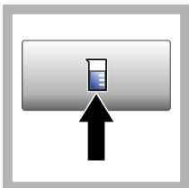
3. [Sample ID (サンプル ID)] を押します。該当するサンプル ID を選択してから、[Select (選択)] を押します。選択したサンプル ID がディスプレイに表示されます。
