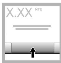
12. [Read (測定)] を押します。装置が測定を完了するのを 1 分間待ちます。
